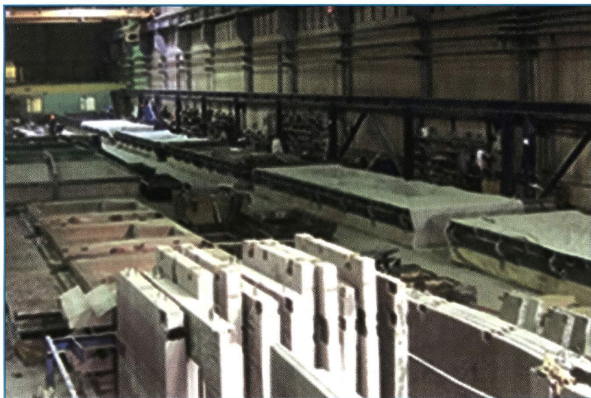
183-й Механический завод. Новая финская стендовая технология изготовления сборного железобетона
