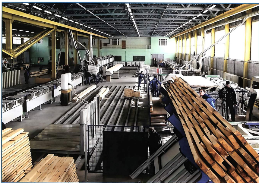
78-й ДОК. Цех изготовления большепролетных деревоклееных конструкций
